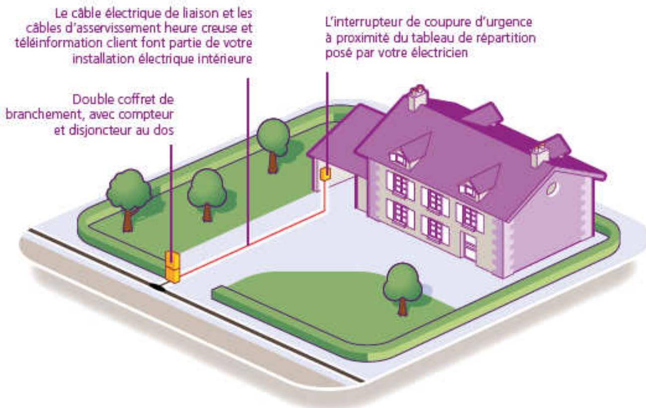
LORSQUE LA LONGUEUR DU CÂBLE DE BRANCHEMENT EN ZONE PRIVATIVE EST SUPÉRIEURE À 30 MÈTRES, OU POUR LE RESPECT DES CHUTES DE TENSION SUR LE BRANCHEMENT
